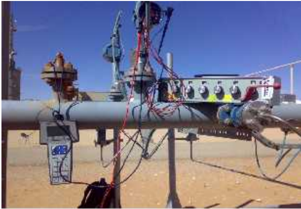
Fig. 2. La chaîne du système de comptage avec les étalons de référence (GTFT).
