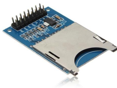
Figure II.11: module pour carte SD
