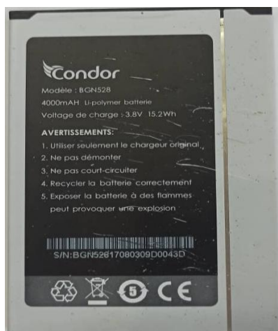
Figure II.14: Batterie utiliser pou alimenté la station
