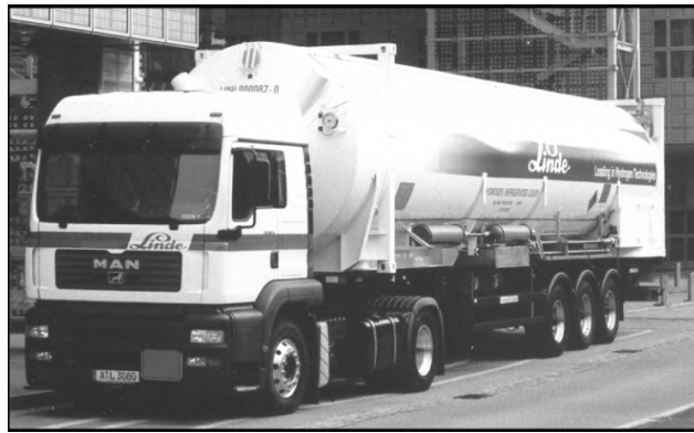
الشكل I.4: خزان لنقل LH2 إلى المستخدم [7]
