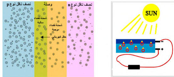
الشكل 21.I: حركة الشحنات ونشوء المجال الكهربائي [31]
