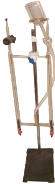
الشكل 7.II: تمثيل تخطيطي لجهاز فولطمتر هوفمان
