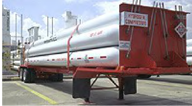
الشكل I.3: مقطورة أنبوب لتوزيع غاز الهيدروجين بكميات كبيرة [7]
