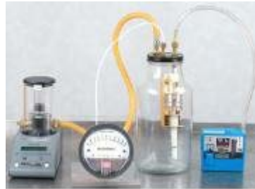
Figure I.7 : Prélèvement des poussières avec un cyclone
