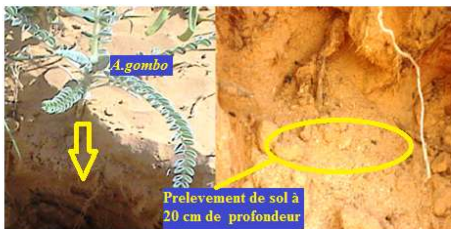
Figure 2.- Prélèvement de sol au niveau de la rhizosphère de l'espèce A. gombo dans un lit d'Oued
