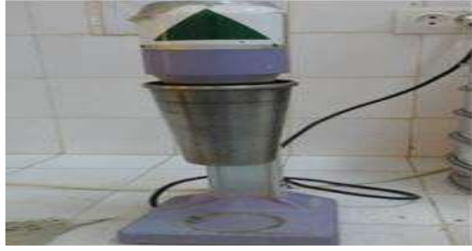
الصورة -7 : خلط العينة بمخلط كهرومغناطيسي
