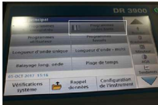
الصورة-24: طريقة ضبط قراءة جهاز DR3900
