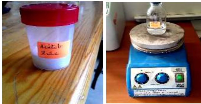
الشكل (III-1): تحضير محلول أسيتات الزنك مذابة في الميثانول.
