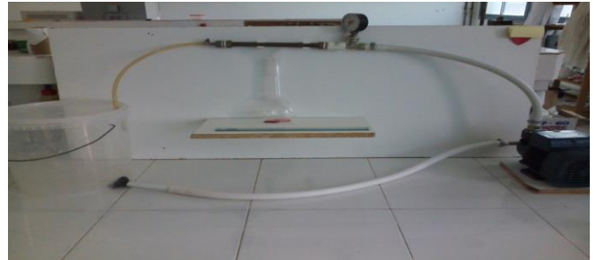
FIG.2 : Le pilote de microfiltration
