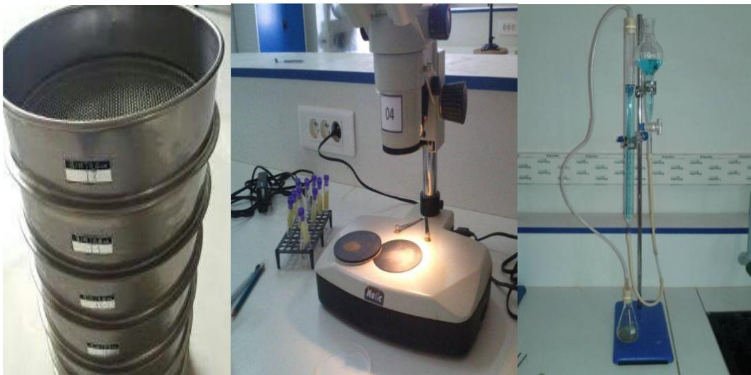
Figure 04: Les tamis      Figure 05 : La loupe biloculaire      Figure 06: Le calcémètre
