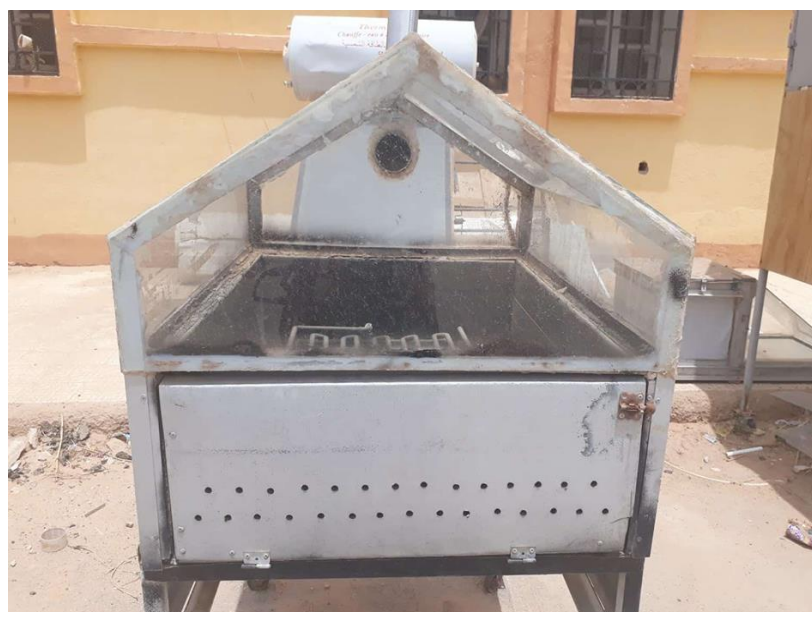
Séchoir solaire direct avec l'appoint énergétique (échangeur)
