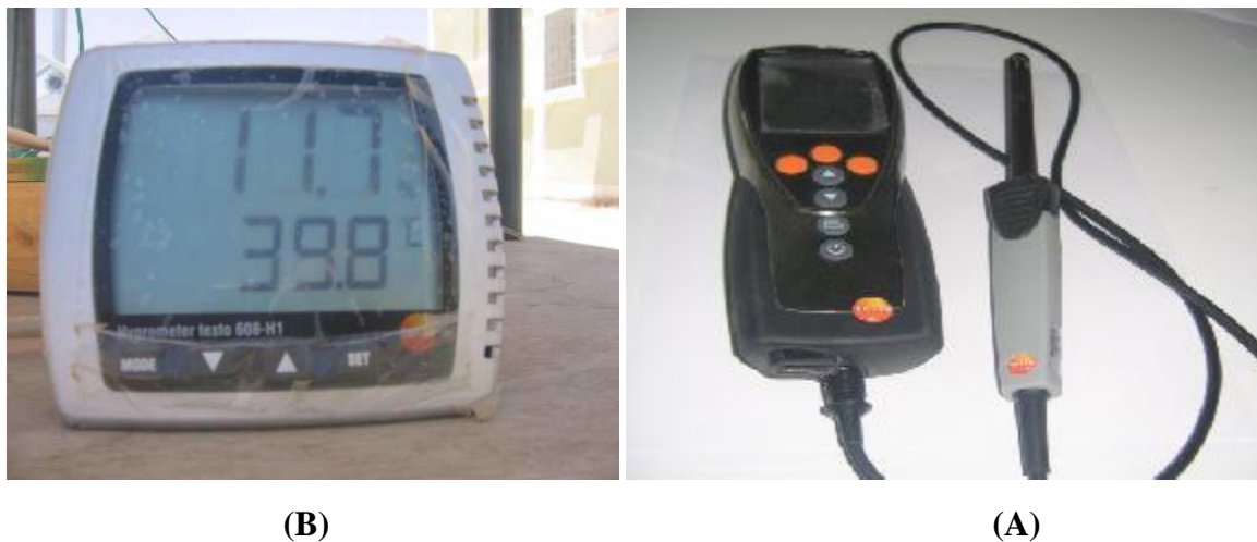
Figure (II.3) :Hygromètre (A) Testo 645 (B) Testo 608-H1
