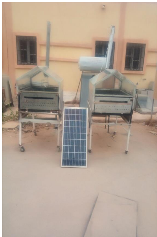
Séchoir solaire direct actif ou forcé
