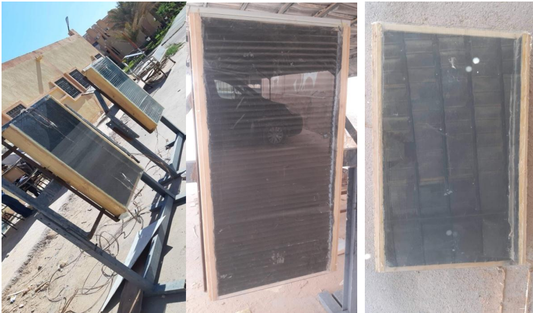
Figure (3.5) : Capteur solaire à air
