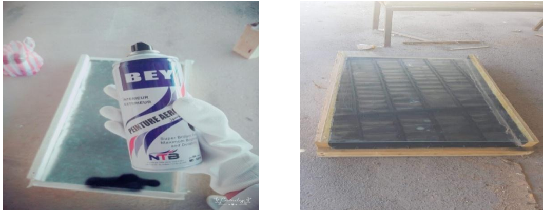
Figure 3.2: Photos représentant la pigmentation de l'absorbeur en noir mat et l'emplacement de la vitre
