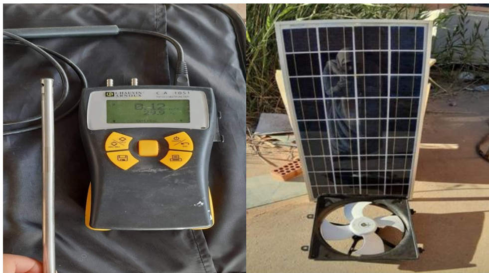
Figure 3.10: Anémomètre + Panneaux PV + ventilateur
