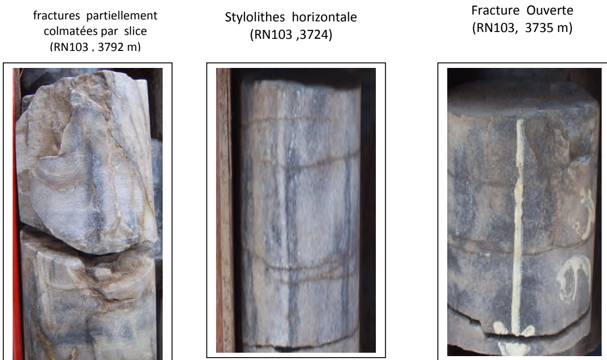
Fig.41: Différente type de fracture sur carotte réservoir QH Puits RN103 (Sonatrach/Reposol, 2005)
