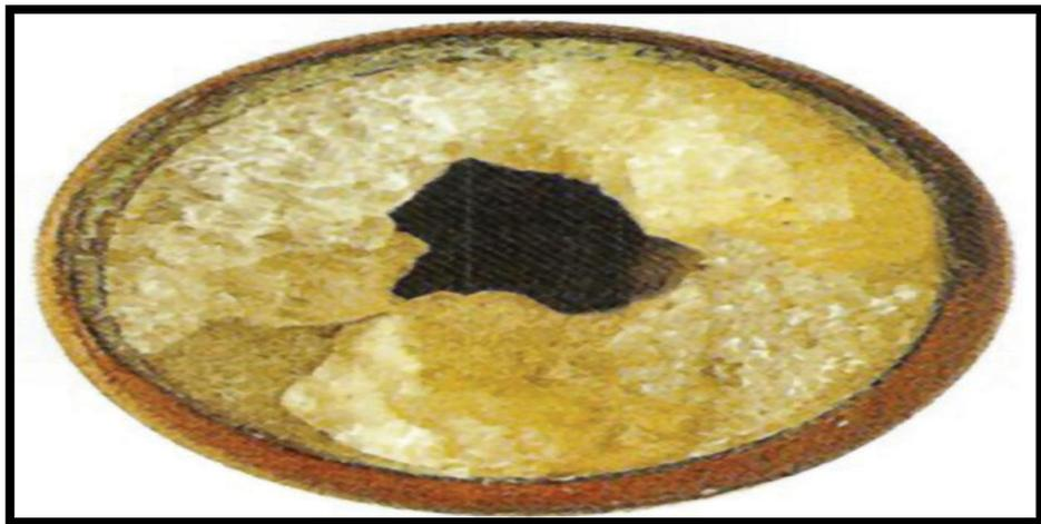
Figure I.1 : Dépôt de chlorure de sodium [1].
