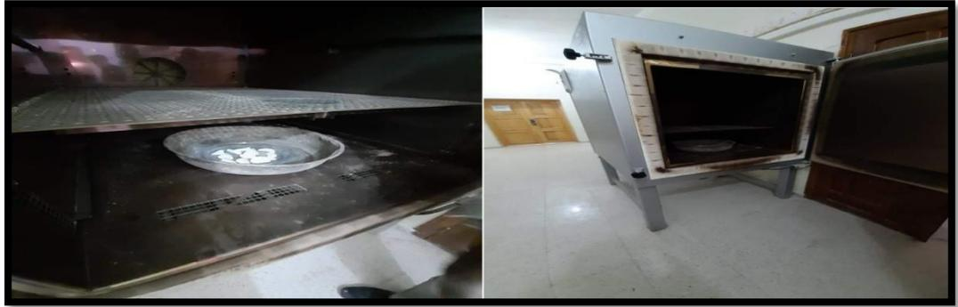
Figure IV.8: Image représente l'étape de séchage.
