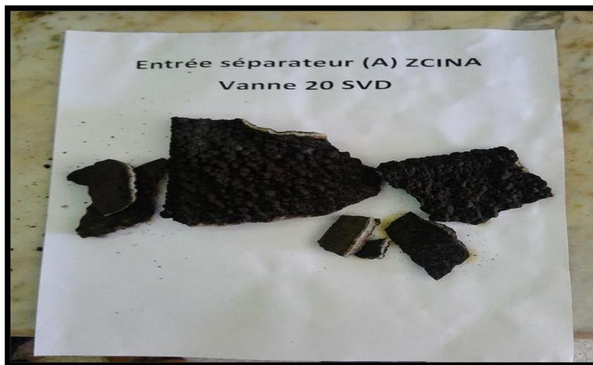
**Figure III.1 :** dépôt récupéré à l'entrée de séparateur ZCINA. [33]
