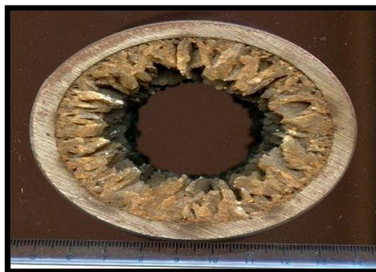
Figure I.3 : Dépôts de CaSO<sub>4</sub> dans une pipe de pétrole [6].
