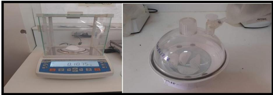
Figure IV.9: Image représente l'étape de poids de filtre après filtration.
