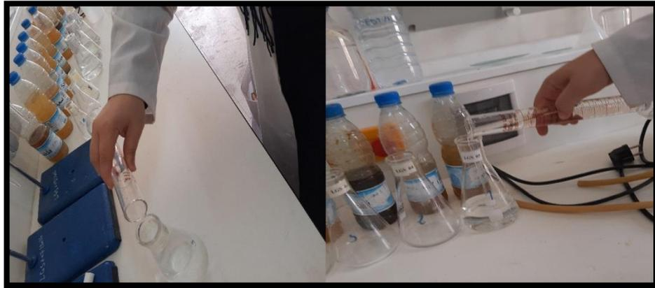
2. Ces fioles sont vidées dans l'ampoule décanter par ordre et le Débit de robinet fixé a  $Q = 8.33 \text{ ml/min}$ .
