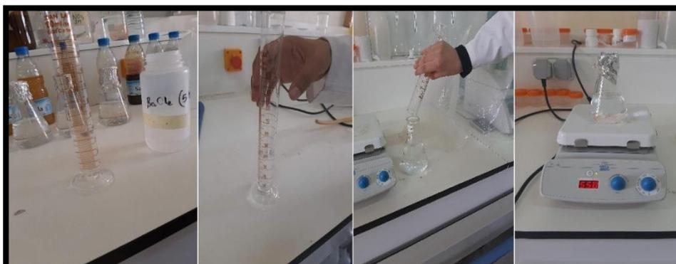
Figure IV.4 : Image représente l'étape d'addition de  $\text{BaCl}_2$ .
