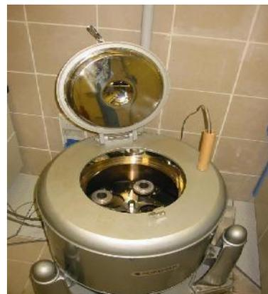
Figure IV.7 Centrifugeuse
