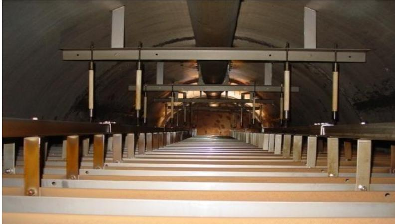
**Figure V.2.** Les électrodes à l'intérieur du dessaleur
