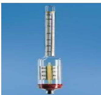
Figure IV.2 Aéromètre
