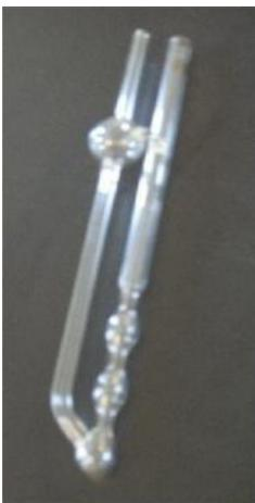
Figure IV.4 viscosimètre
