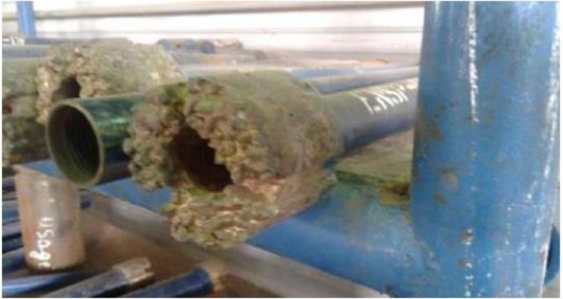
Figure (3.6) : OUTIL DE MILLING
