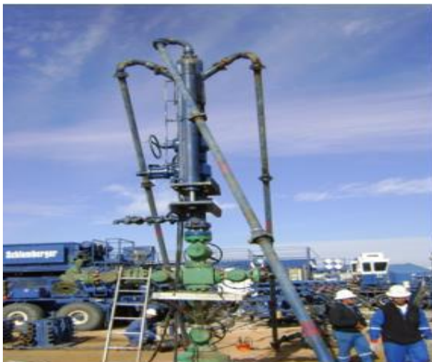
Figure 2.9: Wellhead isolation tool (Outil d'isolation de tête de puits) [4]
