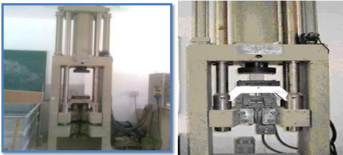
Figure 16 : Presse du béton CONTROLS
