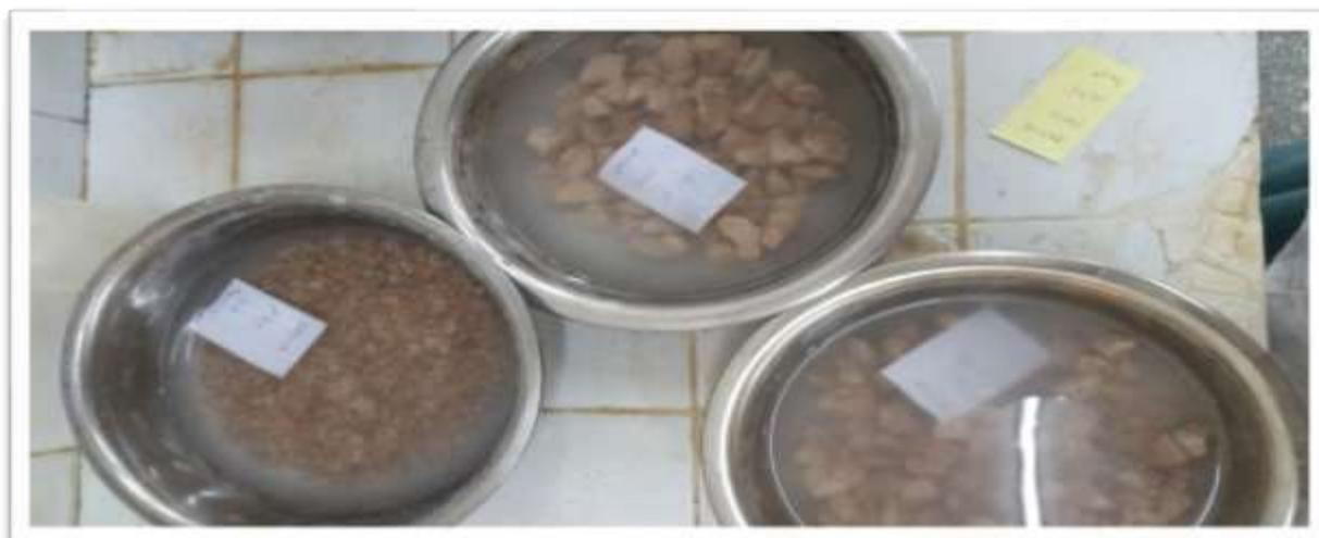
Figure 08 : Absorption d'eau pour les trois fractions de gravier
