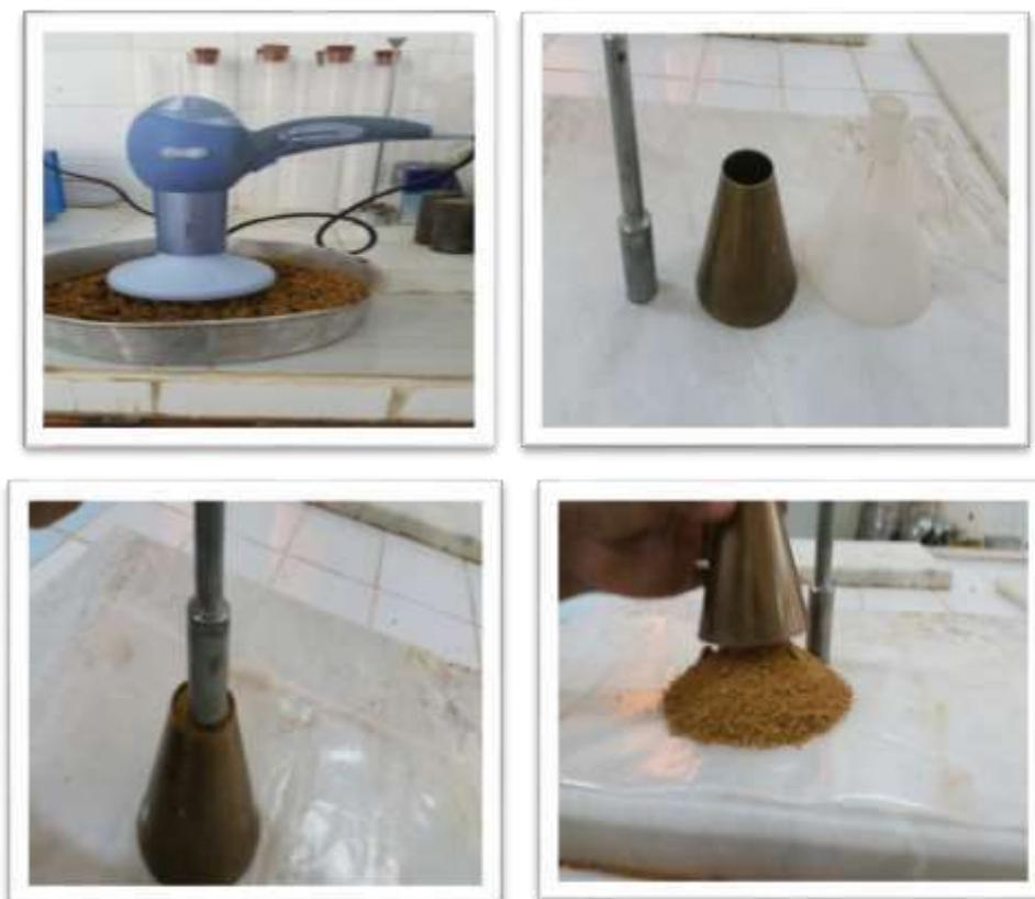
Figure 05 : Essai d'absorption d'eau pour les sables
