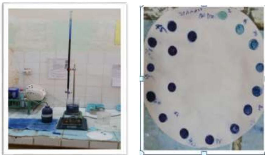
Figure 07: Essai du bleu de méthylène
