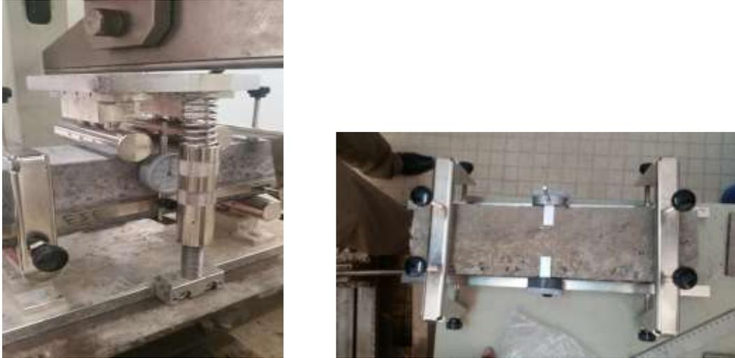
Figure 4-3 positions des comparateurs sur l'éprouvette
