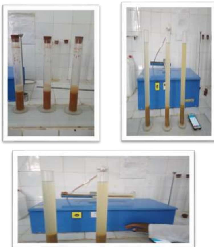
Figure 06 : Essai de l'équivalent de sable.
