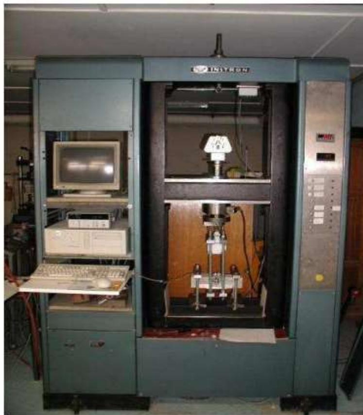
Figure 31 : presse universelle INSTRON d'essai de flexion[4]
