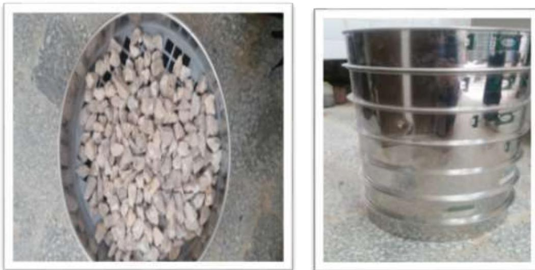
Figure 01 : Analyse granulométrique par tamisage
