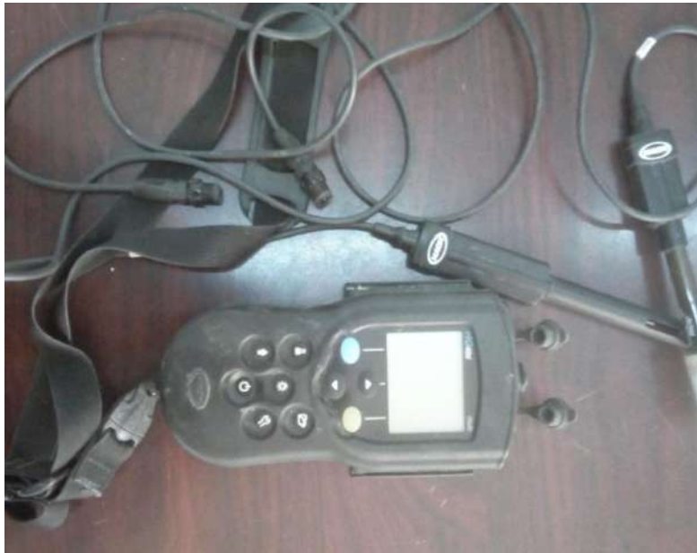
Fig. 16. Multi-Paramètre HQ40d utilisé pour les mesures in-Situ
