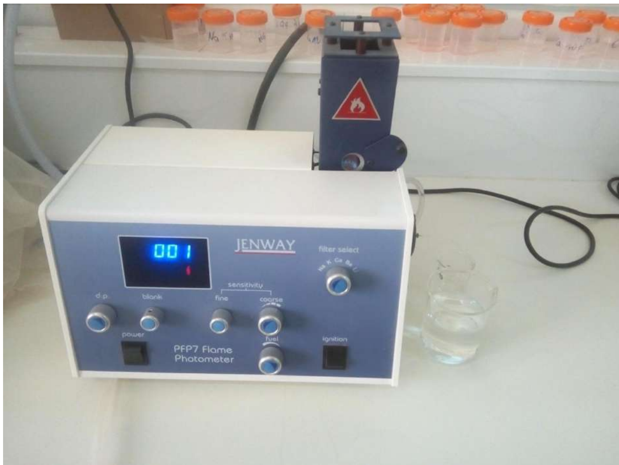
Fig. 18: Photomètre à flamme utilisé pour l'analyse du lithium (JENWAY PFP 7)
