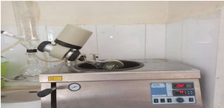
الشكل 17 : صور توضح جهاز Rotavapour المستعمل في الدراسة
