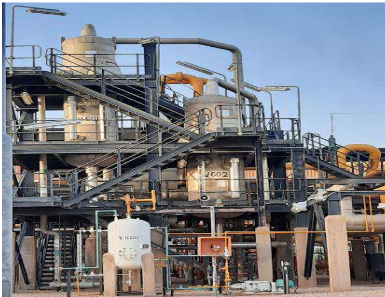
Figure (IV.2) : Echangeur à plaque E601 et deux ballons de propane V601 et V602.
