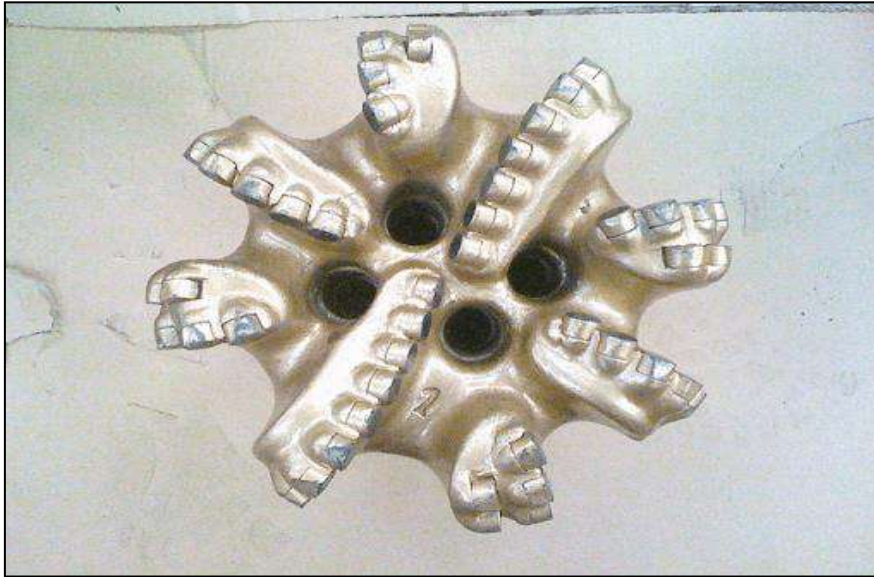
Figure I.16 : L'outil à diamant (PDC).
