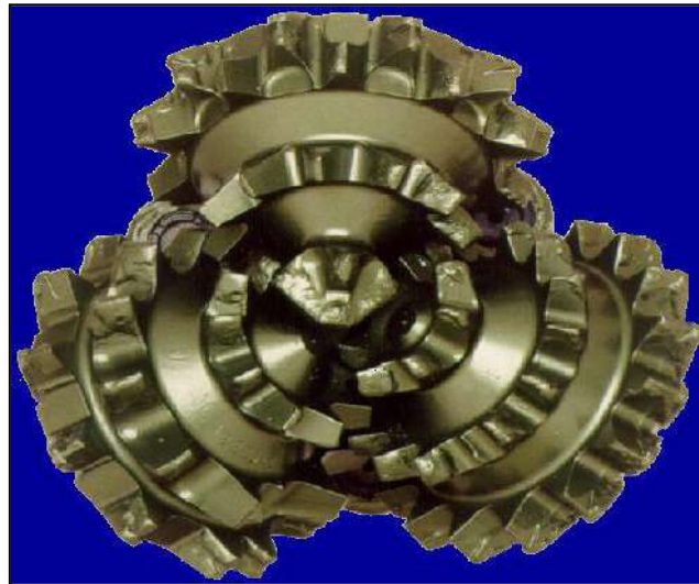
Figure I.8 : Tricône à dents en acier [5].
