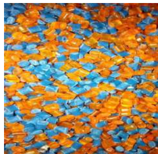
Figure III.5 : Photographie du mélange granulaire de PA (bleu) et de PC (orange).
