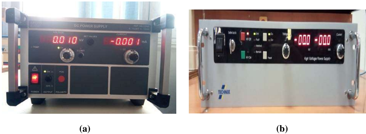
Figure III.2: Alimentation haute tension continu ; (a) polarité positive, (b) polarité négative
