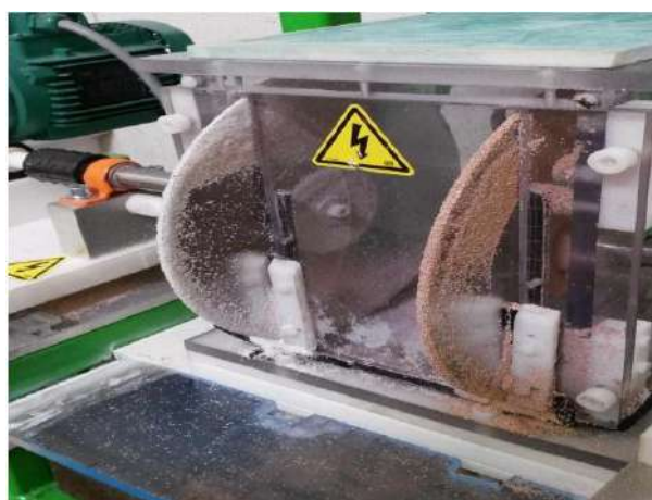
Figure II.26. (a) : photographie et (b) : représentation schématique d'un séparateur tribo-aéro-électrostatique à disques tournants.
