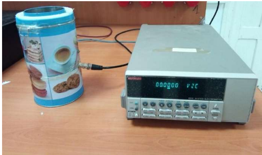
Figure III.7 : La cage de Faraday reliée avec l'électromètre au laboratoire LGEG
