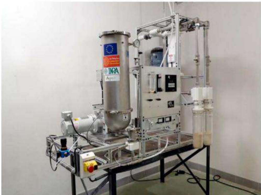
Figure II.23. Photographie d'un séparateur tribo-aéro-électrostatique
