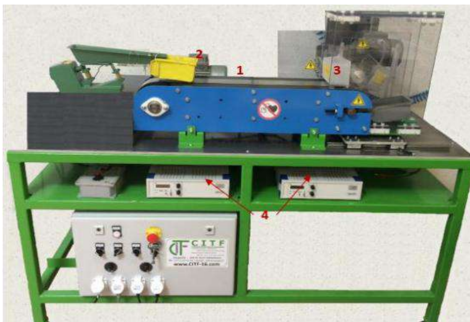
Figure II.21. Séparateur électrostatique à tapis roulant.
