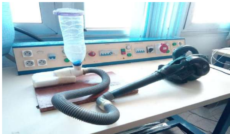
Figure III.5 : Dispositif de triboélectrisation à lit fluidisé au laboratoire LGEG.
