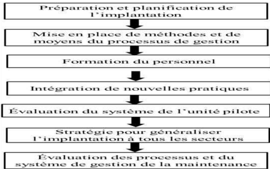
FIGURE IX.13: Étapes de la mise en place d'un système de gestion de la maintenance.
