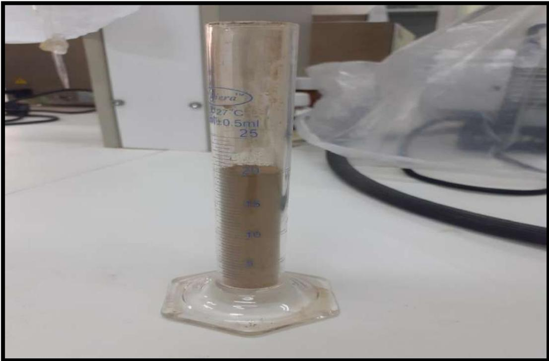
الشكل 15: تجربة قياس الكتلة الحجمية
