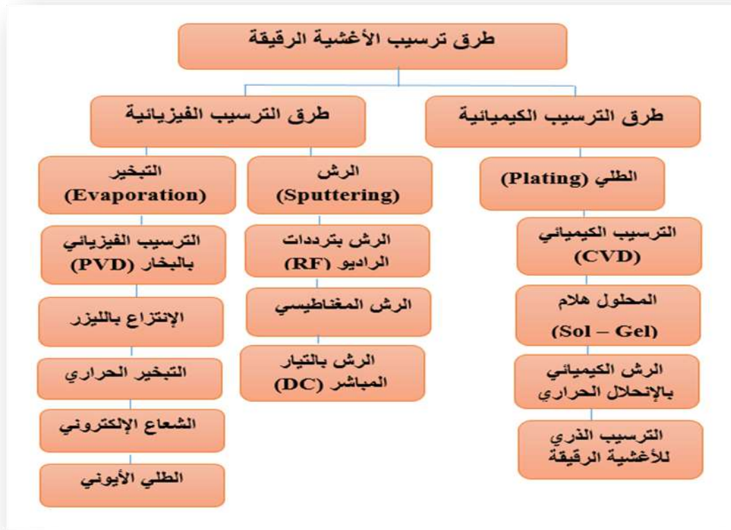
الشكل (1.II) : مخطط يوضح التقنيات المختلفة لترسيب الأغشية الرقيقة [3, 4].
