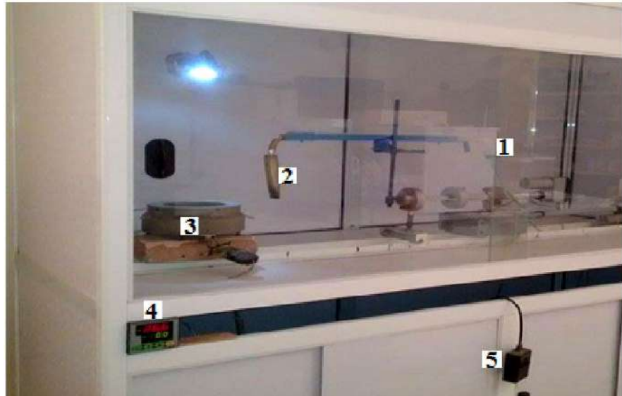
الشكل (1.III) : التركيب التجريبي لترسيب الأغشية الرقيقة " تقنية الإنحلال الحراري".
