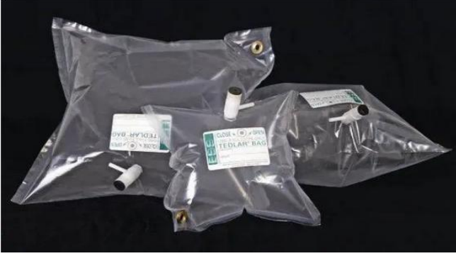
الشكل (8) : حقيبة Tedlar لأخذ عينات الهواء و الغاز.
