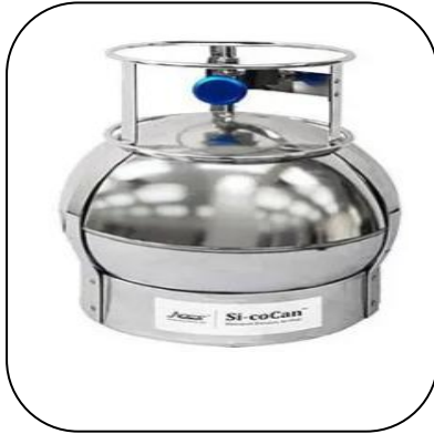
الشكل (10) : علبة SUMMA لأخذ عينات الهواء.
