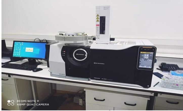
الشكل(10-I): صورة لجهاز GC-MS.
