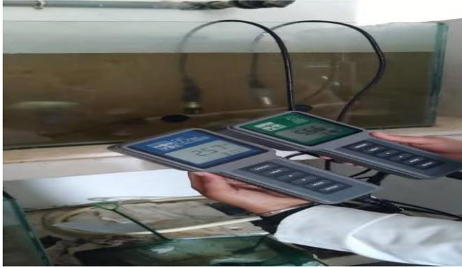
الشكل (32): جهاز متعدد قياس YSI63 / YSI85
