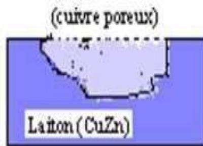
الشكل(06): يوضح التآكل الاختياري
