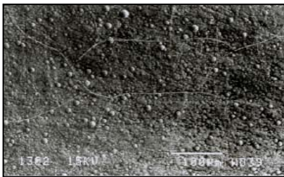
Fig.VI - a : Aspect de surface d'un dépôt de chrome dur en sortie du bain (fissuration apparente)
