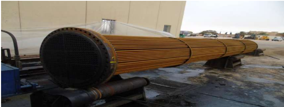
Figure III.4: faisceau tubulaire d'un échangeur à tube et calandre
