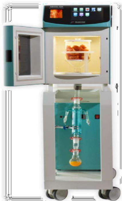
Fig12: L'extraction par micro-ondes combinant l'hydrodiffusion et la gravité [21].
