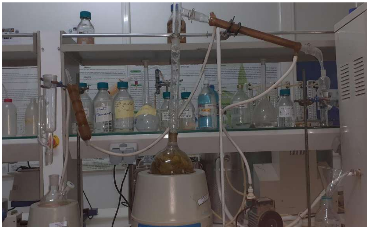
Figure15: montage d'hydrodistillation utilisé lors d'extraction de l'HE des feuilles de citron
