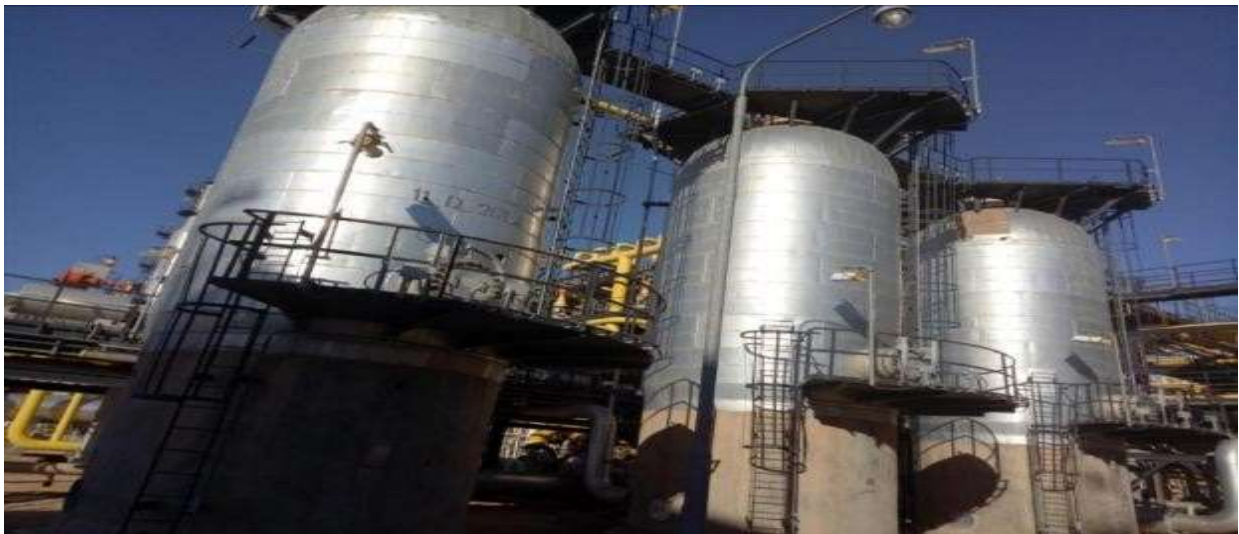
Figure 2. Les trois déshydrateurs [9]
