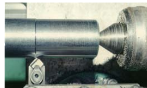
Fig.3 : Epreuve d'essai en Acier XC 42 Dimensions : ( \varnothing 90x500)
