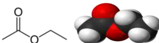
Figure II-2 : Structure moléculaire de l'acétate d'éthyle.
