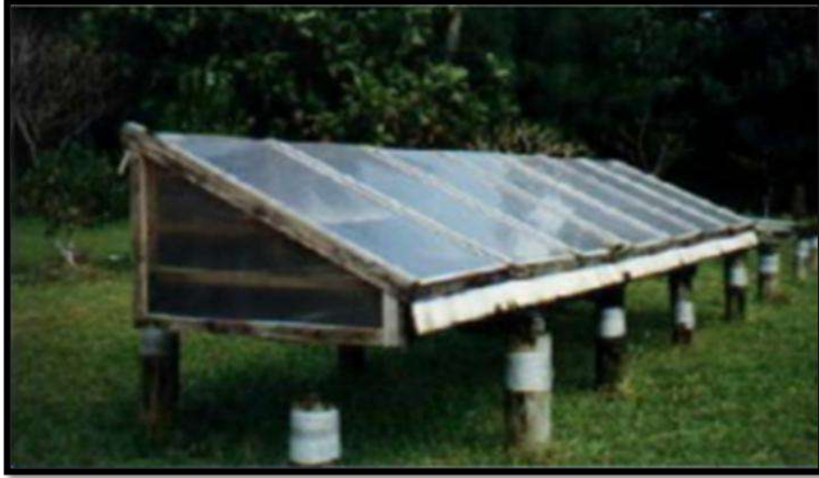
الشكل (11.I): صورة للمجفف الشمسي المباشر (قادري، 2019)
