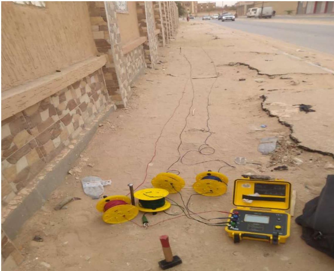
Figure 3.2 : principe de la mesure de résistivité du sol par la méthode de Wenner (a- distance entre deux piquets, b- profondeur d'enfoncement des piquets) dans le terrain
