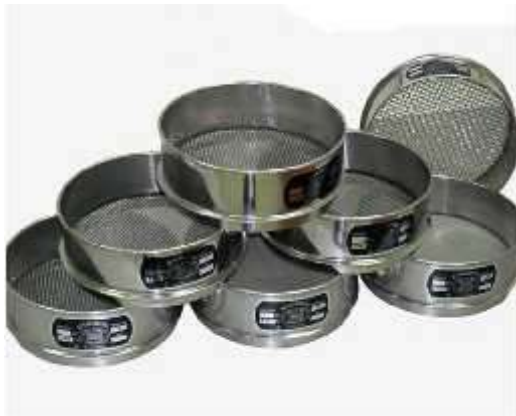
Figure II.1 : Série de tamis pour granulométrie.
