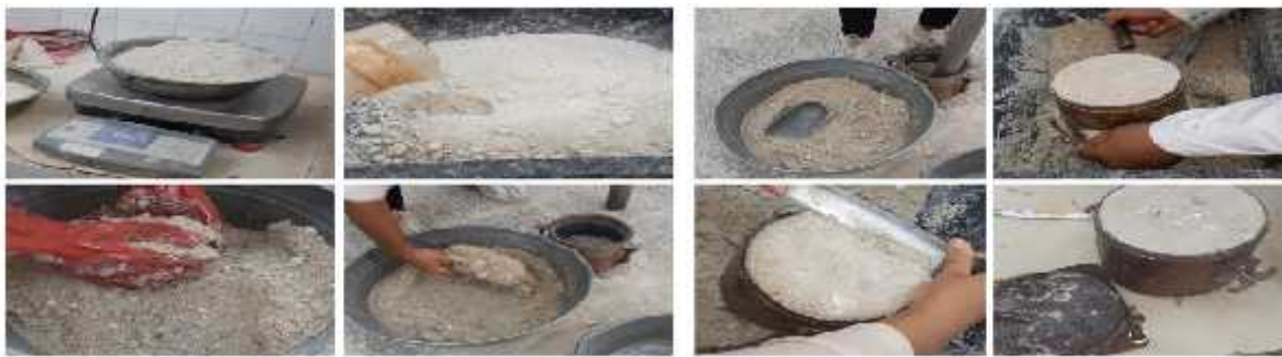
Essai Proctor ajoute les l'eau Essai Proctor après compactage
