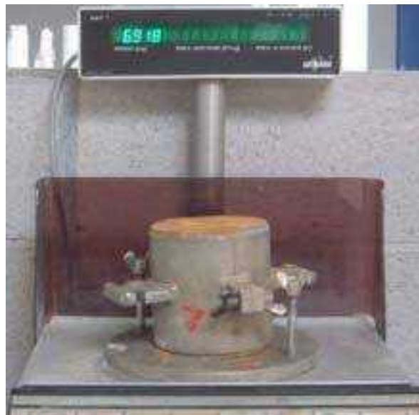
Figure II.8 : Tuf dans le moule Proctor
