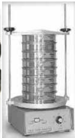
Figure II.1 : Série de tamis pour granulométrie.
