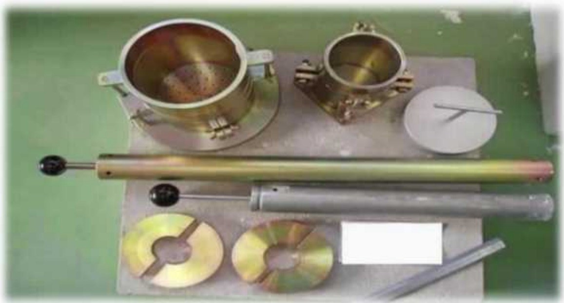
Figure II.6 : Matériels pour essai Proctor
