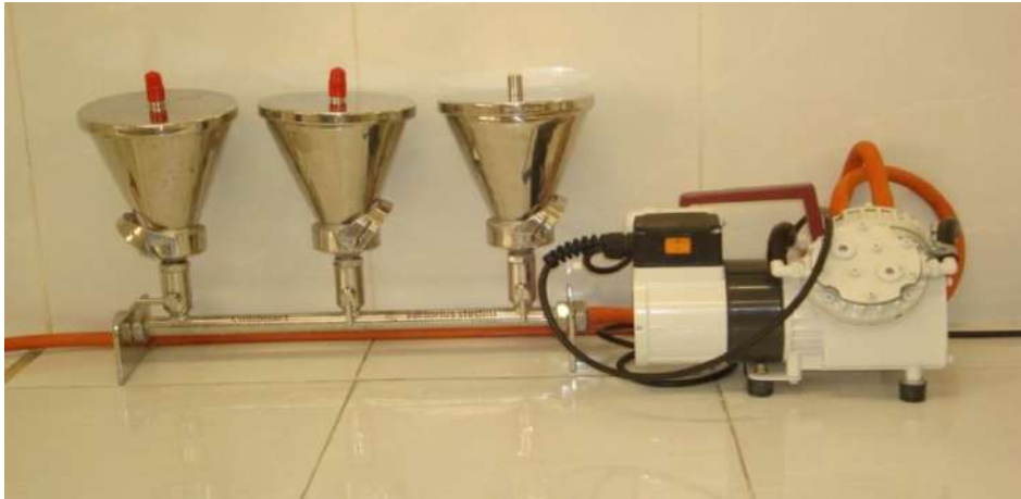
Photo IV.3 Unité de filtration avec pompe à vide
