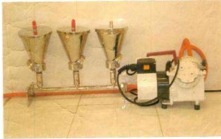
Unité de filtration avec pompe à vide
