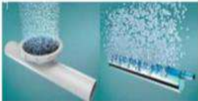
الشكل ( 18 ) : عملية حقن الأوزون داخل الوسط المائي.
