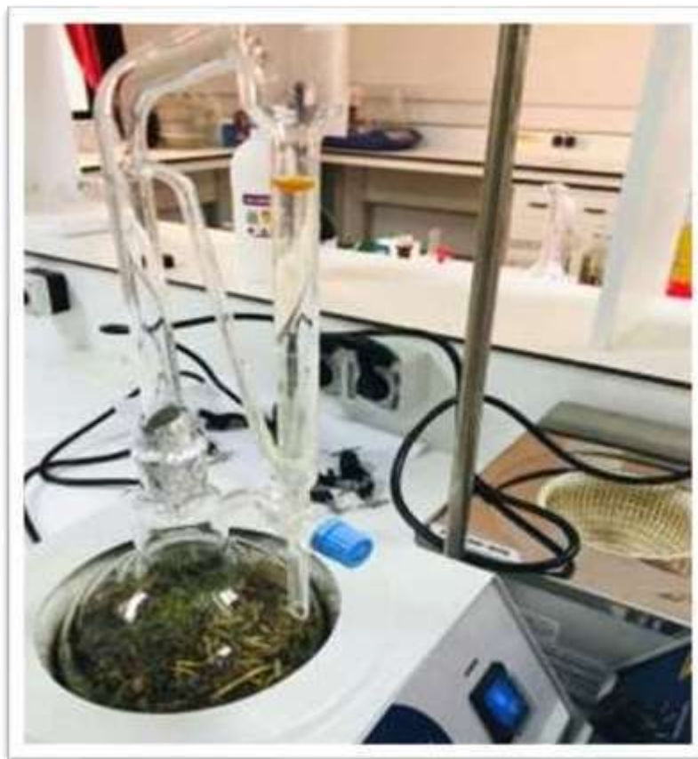
Figure II.1 : l'extraction des huiles essentielles par Clevenger.
