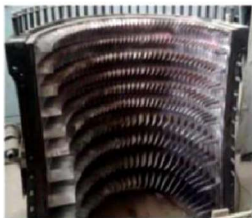
Fig (II.2-b): Stator du compresseur
