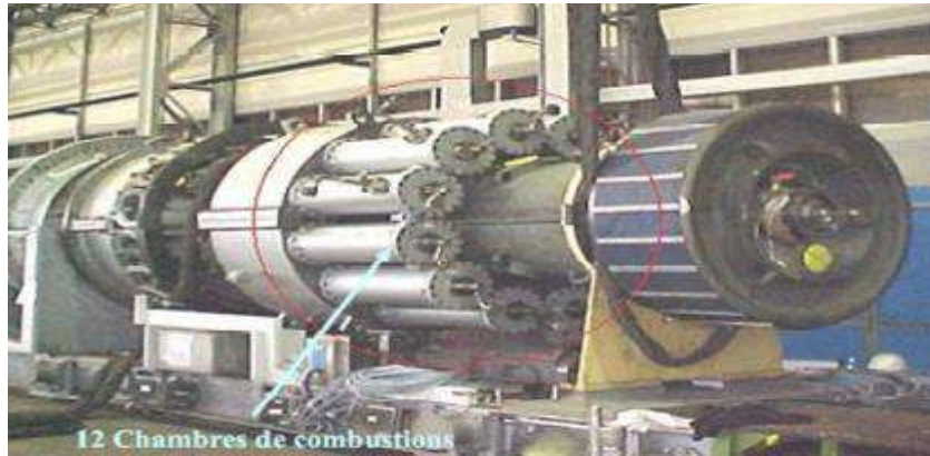
Fig (III.5) : Chambres de combustion turbine à gaz [10]
