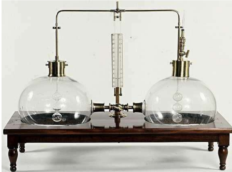
Fig (I.2) : Dispositif de Gay-Lussac pour l'étude des détentes [03]
