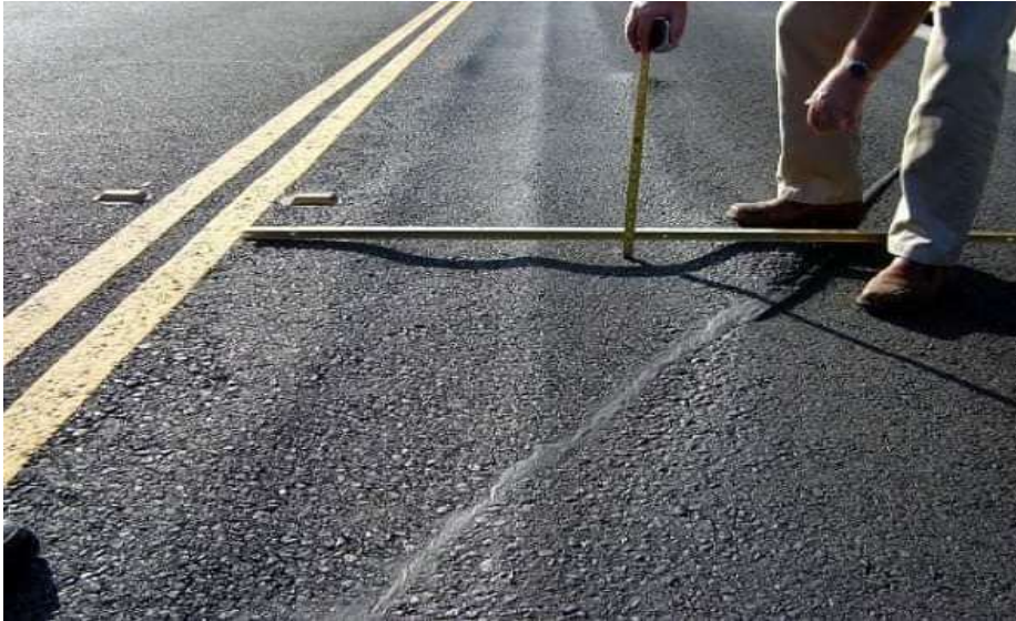
- الشكل رقم (10) تبين كيفية قياس عمق هبوط الأخدود -
