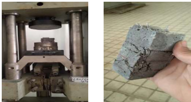
PhotoIII.4 : Essai de résistance à la compression
