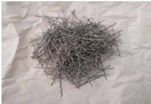
Photo II.5: La géométrie de fibres métalliques utilisées
