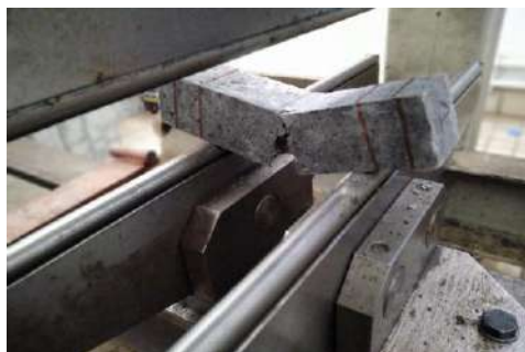
Photo III.3: Essai de résistance à la flexion (3 point)
