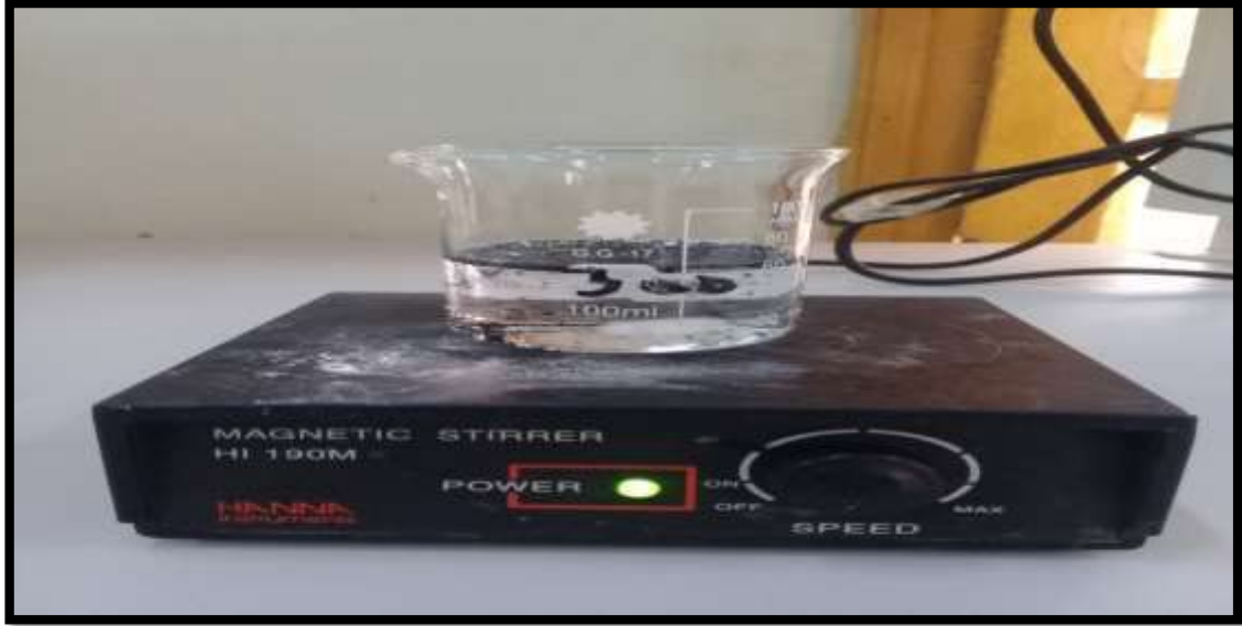
الشكل (23): عملية إمتزاز النترات بواسطة الفحم المنشط فوق جهاز الخلاط المغناطيسي .
