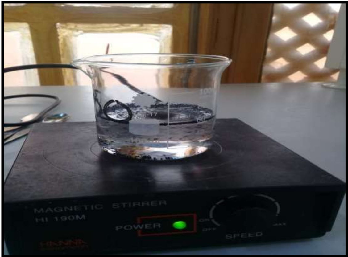
الشكل (23): عملية إمتزاز النترات بواسطة الفحم المنشط فوق جهاز الخلاط المغناطيسي .
