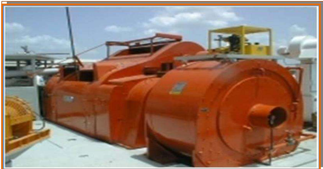
Fig. I.9 : Treuil de forage [11]
