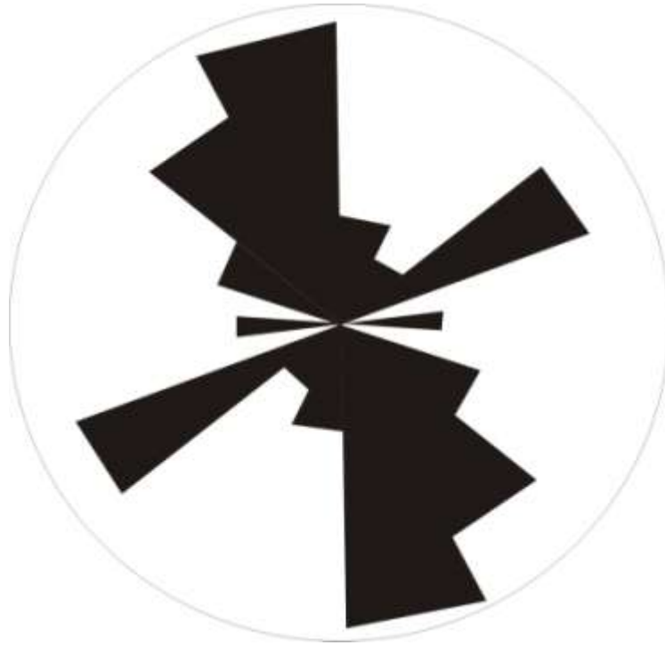
Figure .15 : Rosace de distribution directionnelle des diaclases ( Secteur d'ElBordj)
