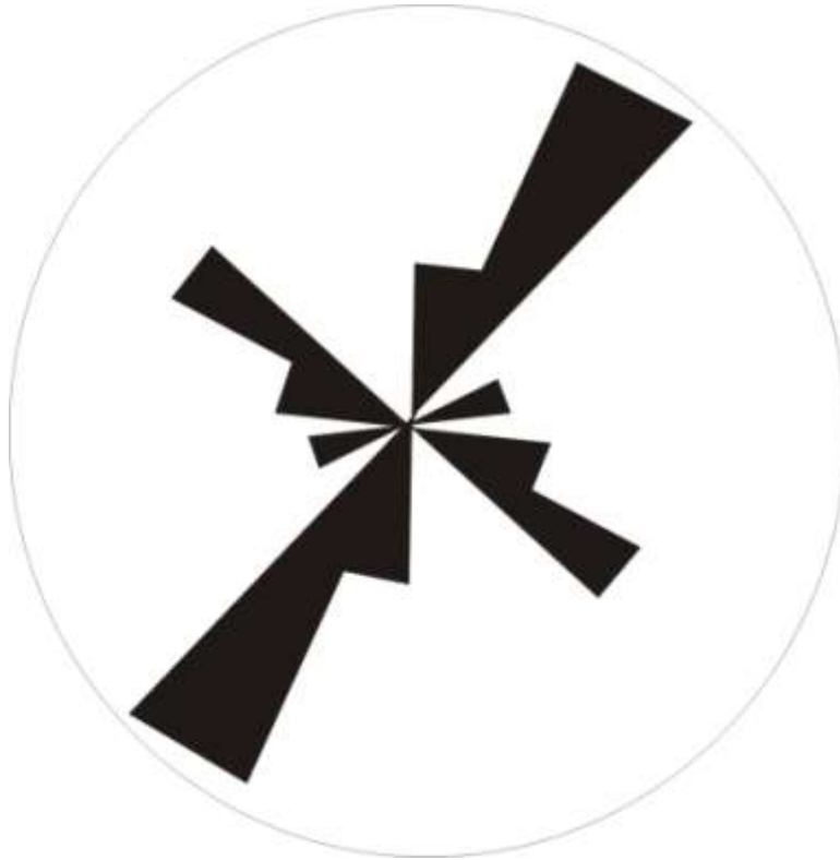
Figure .13 : Rosace de distribution directionnelle des diaclases (Secteur deSekkak )
