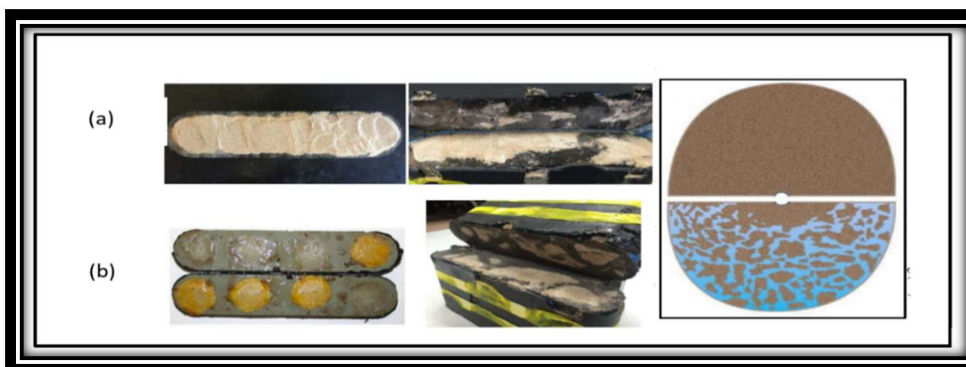
Figure II.8: Deposition des proppant dans les fractures pour les deux méthode de fracture [5]
