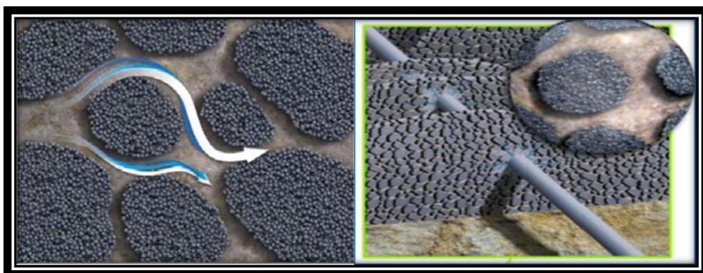
Figure II.1 : Les canaux à haute conductivité créés entre les piliers de proppant (Presentation prepared for Jornada De Maxi-Fracturas May 2012 Slb).
