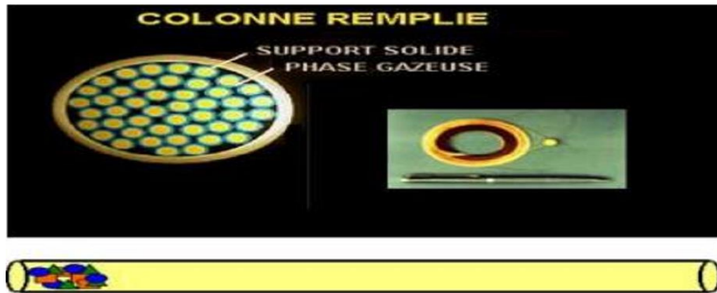
Fig. 13- Colonne de chromatographe (DATALOG doc, 1999).
